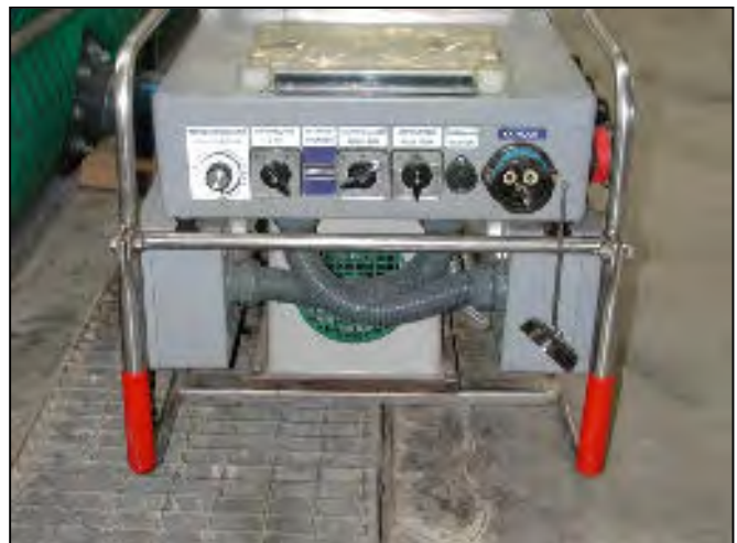
Figura 4.5 – Pannello dei comandi e delle regolazioni dell'elettrostorditore.
