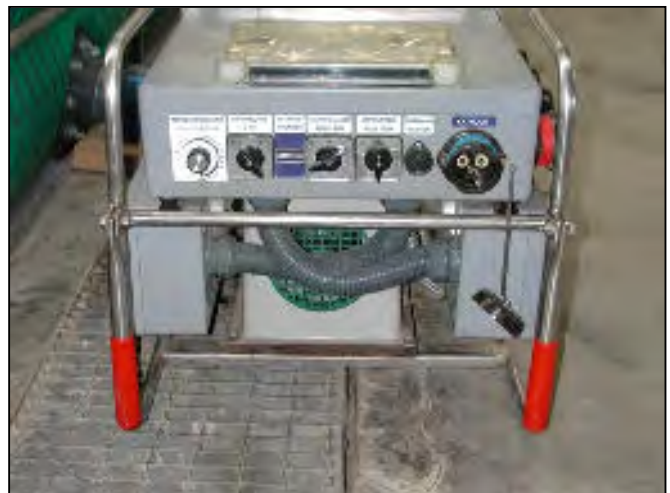
Figura 4.5 – Pannello dei comandi e delle regolazioni dell'elettrostorditore.
